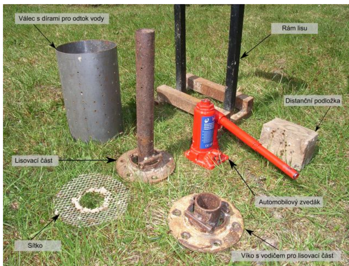
Obrázek 7: Součásti lisu
