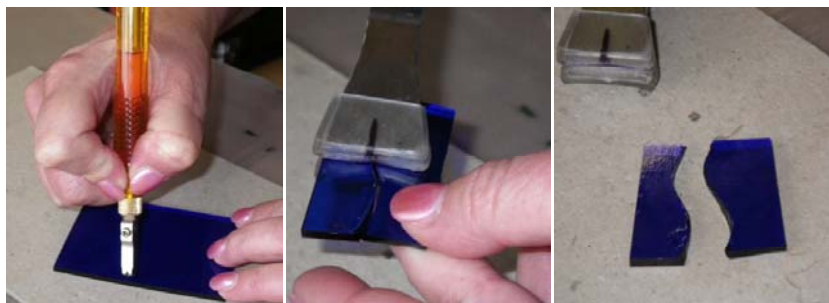
Obr. 3 Postup dělení skla
