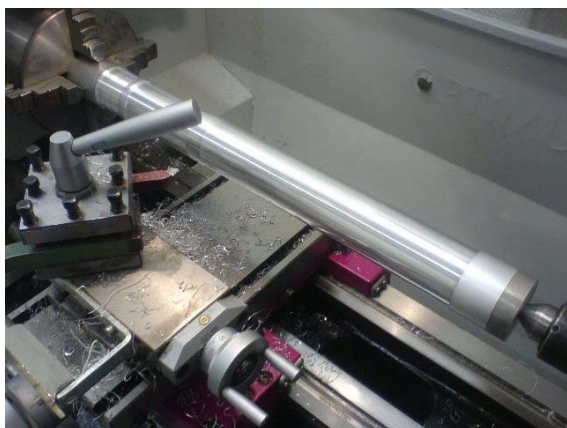
Obrázek 4: Soustružení hlavěň
