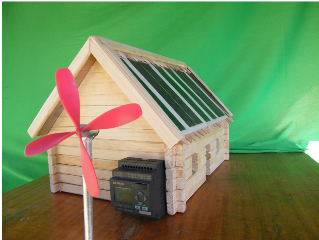
Obrázok 1 Pohľad na model domčeka, kde je vidno fotovoltaičné panely, taktiež veternú turbínu a aj samostatný riadiaci systém
