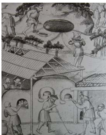
Obr. 1 Sklářská huť s tavicí a chladicí pecí
