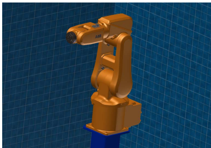
Rys.2 Wykonany model robota IRB 120
