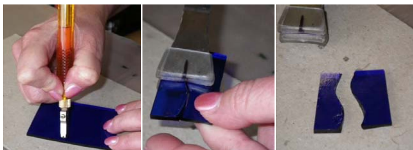
Obr. 3 Postup dělení skla
