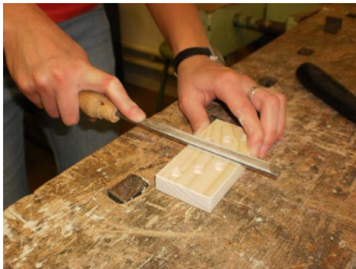
Obrázek 2 Pilování středové čáry
