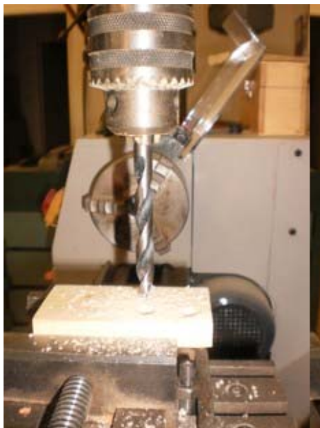
Obrázek 3 Vrtání děr
