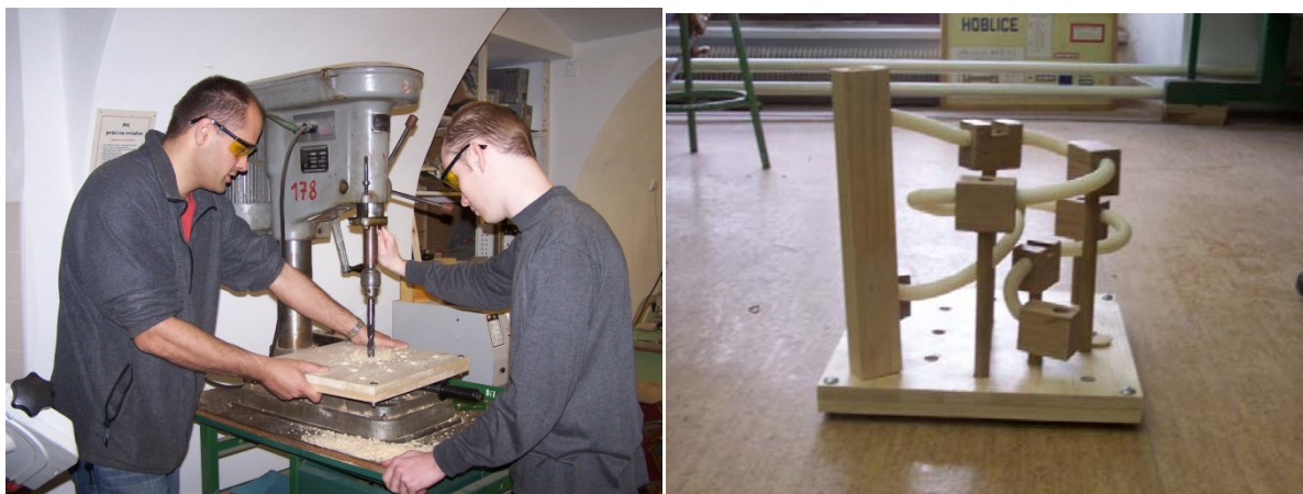
Obr. 12 – 13 Vrtání děr základního dílu a hotový sestavený výrobek
