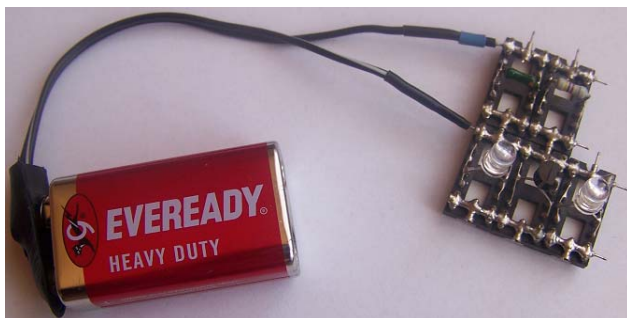
Obr. 16: Osvětlený fototranzistor je otevřen, uzemní tak bázi tranzistoru, takže je zavřený a LED diodou neprochází proud - nesvítí
