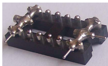
Obr. 4: Patice s přiletovanými piny
