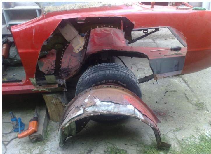
Obr. 1 : Poškodenia karosérie a podblatníka
