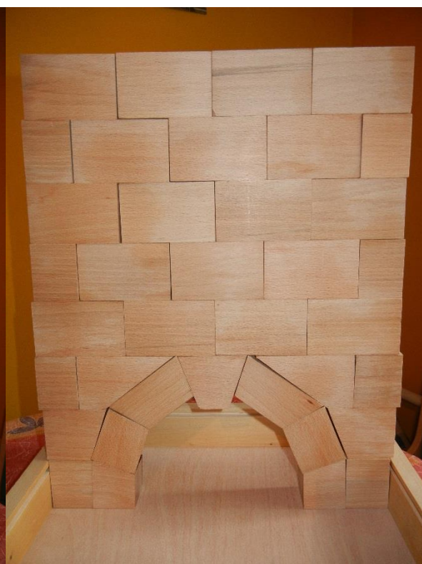
Obrázek 13 – zatížený samonosný oblouk
