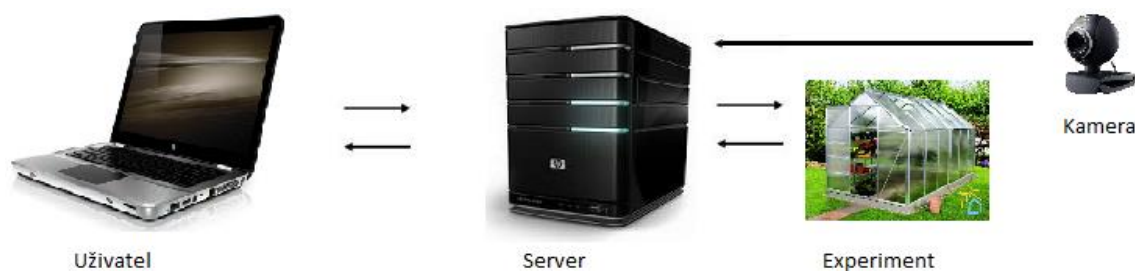
Obrázek 5: Schéma vzdáleného experimentu 17
